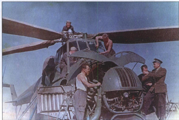
Обслуживание двигателя АШ-82, установленного в носовой части Ми-4
