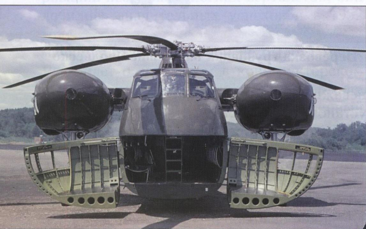
Открытые носовые створки грузового отсека вертолета S-56
