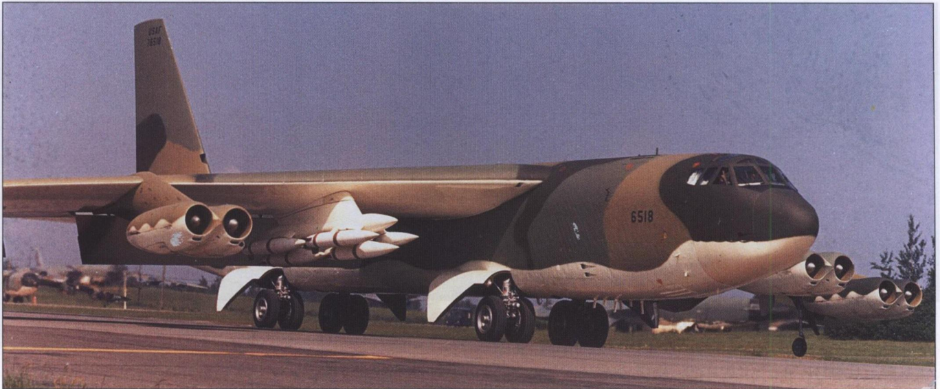
Американский бомбардировщик В-52 с ракетами SRAM на пилоне под крылом
