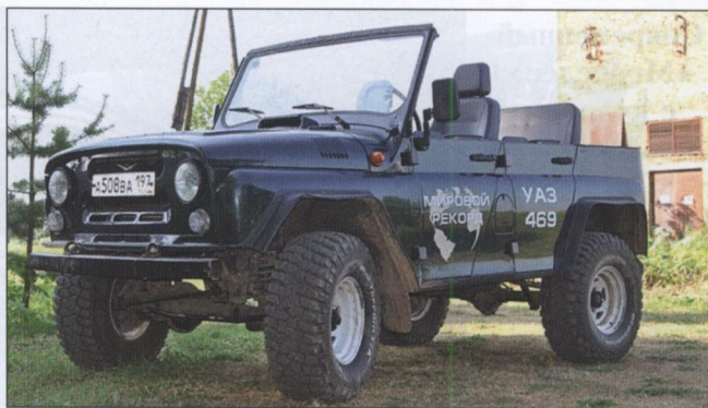
Обычный УАЗ-469 со снятыми боковыми окнами и крышей превращается в типичный «Фаэтон»
