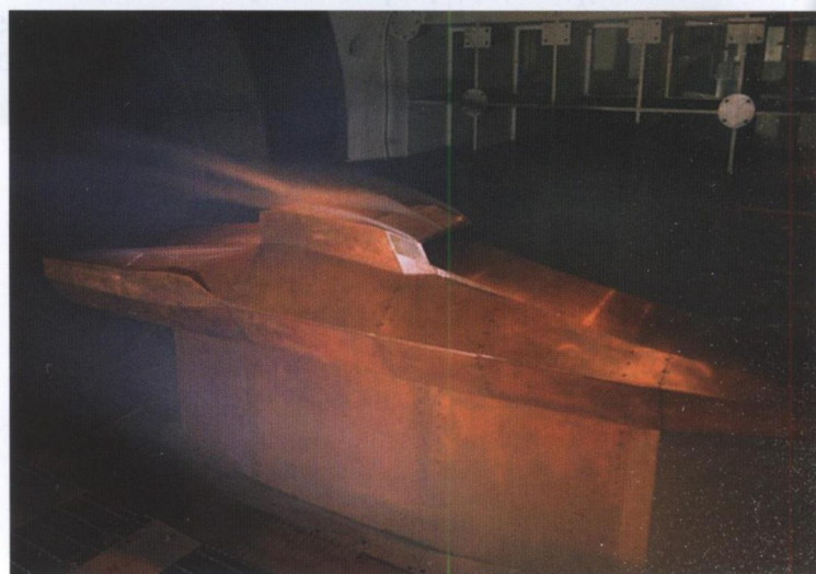
Испытания плоского воздухозаборника гиперзвукового двигателя в аэродинамической трубе с нагревом
